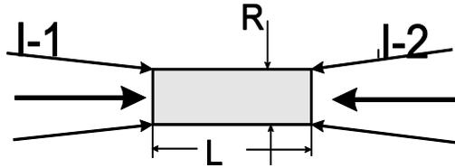
Здесь  $N_{\text{int}}$  – число взаимодействий пучка с мишенью;  $I$  ток пучка;  $F = I/e$  – число частиц в пучке, падающих на мишень в единицу времени;  $e$  – заряд частиц пучка;  $\rho$  – плотность мишени или пучка (число ядер в единице объёма);  $l$  – толщина мишени;  $\sigma$  – сечение взаимодействия частиц пучка с частицами мишени.
